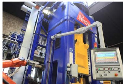
Highlight in der Schmiede: die neue Spindelpresse für die wirtschaftliche Warmumformung größerer Bauteile.
